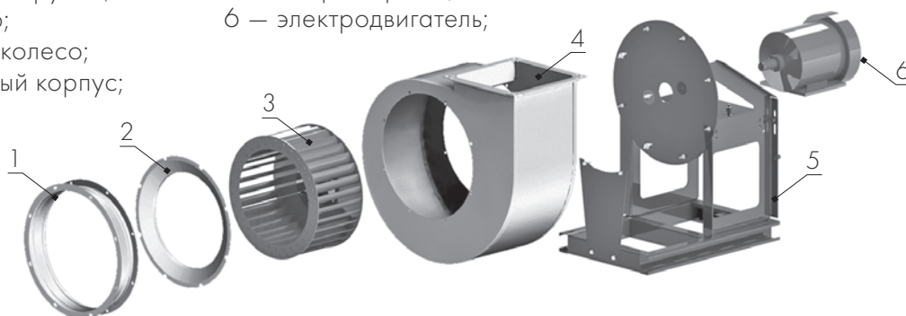
Рис. 4. Устройство и основные элементы радиального вентилятора
